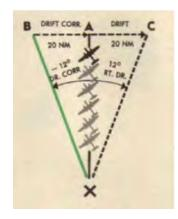
**Figure 4.7 Drift correction**<sup>60</sup>
