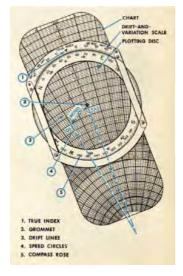
**Figure 4.9 E6-B wind triangle solution**<sup>70</sup>
