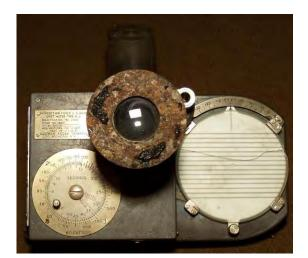
**Figure 4.16 B-5 Driftmeter**<sup>98</sup>
