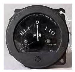
**Figure 3.14 Pilot Direction Indicator (PDI)**<sup>113</sup>
