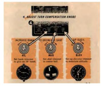
**Figure 3.24 Autopilot turn compensation**<sup>163</sup>
