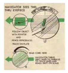
Figure 4.17 Using the Driftmeter<sup>100</sup>
